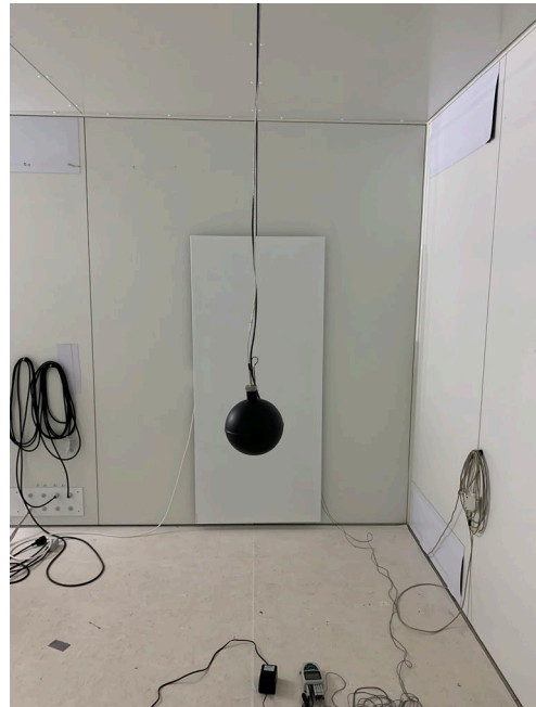
Abbildung 4: Versuchsaufbau Infrarotheizung (Seitenwand) IRH_SW ( P_{el} = 1500 \text{ W} )
