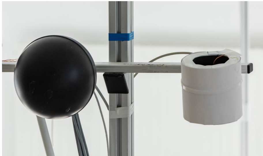
Bild 23: Detailaufnahme eines passiv strahlungsgeschirmten Lufttemperatursensors (rechts). Links ein klassisches Globethermometer (© Fraunhofer IBP).
