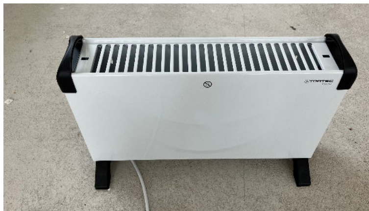
Bild 6: Elektrokonvektor für die energetische Nullmessung (© Fraunhofer IBP).
