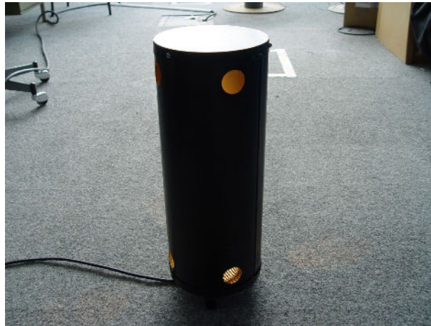
Bild 17: Abbildung eines Kühllastsimulators zur Simulation der nutzungsbedingten Wärmeabgabe durch Personen, Beleuchtung und Geräte (© Fraunhofer IBP).
