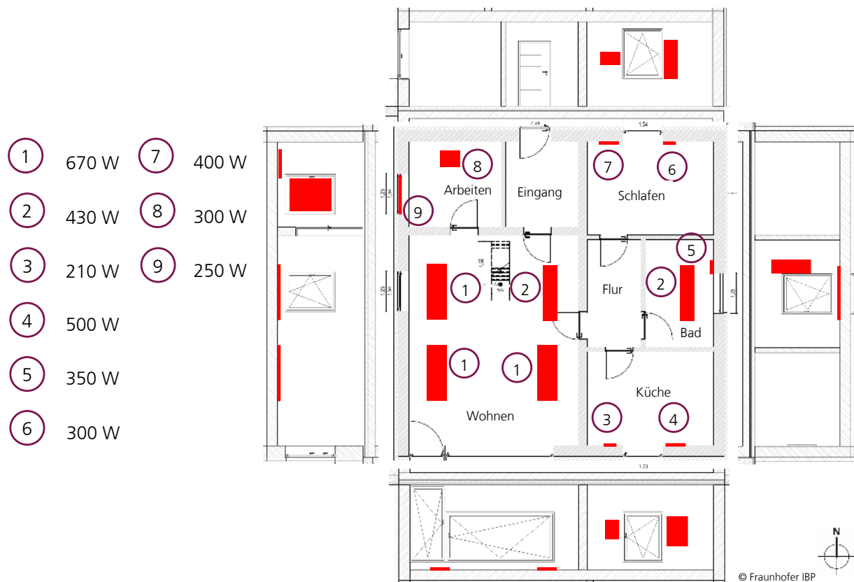
Bild 9: Leistung und Positionierung der Infrartheizungen im Erdgeschoss.
