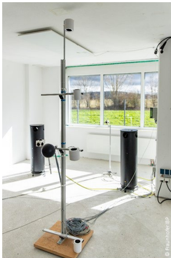
Bild 26: Vollständige Komfortmessstelle im Wohnzimmer.
