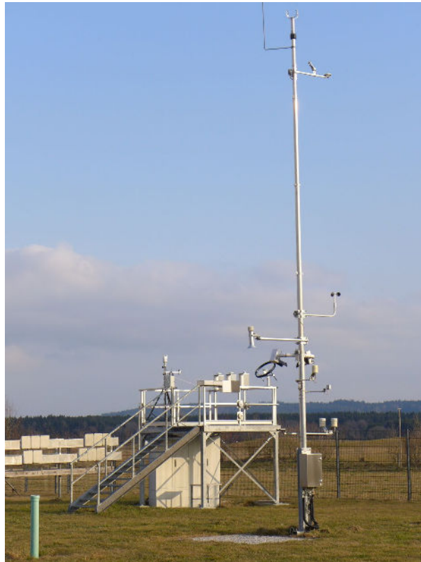
Bild 27: Wetterstation auf dem Freiland-Versuchsgelände des Fraunhofer IBP bei Holz- kirchen (© Fraunhofer IBP).
